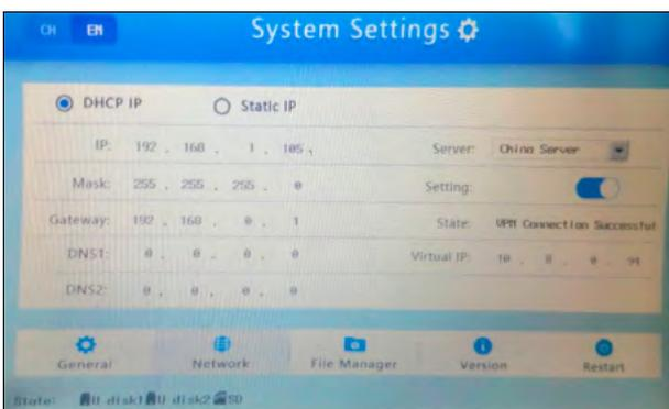
A questo punto il pannello si collega automaticamente alla VPN. Se l’operazione va a buon fine, in “State” apparirà la scritta “VPN connection successful” e verrà visualizzato l’indirizzo IP virtuale assegnato dal server VPN.
